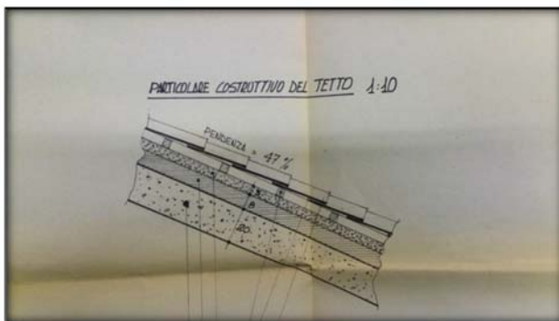
Figura 38: Dettaglio rifacimento copertura in latero cemento
